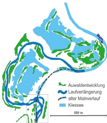
Beispiel für Laufverlängerung am Main bei Unterbrunn.
